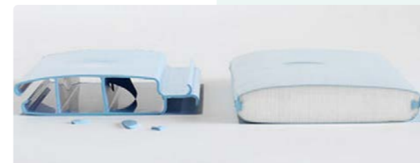
Après le test de grêle, conduit par un laboratoire externe et indépendant. À gauche : lames creuses standard À droite : lames Covrex® Classic
